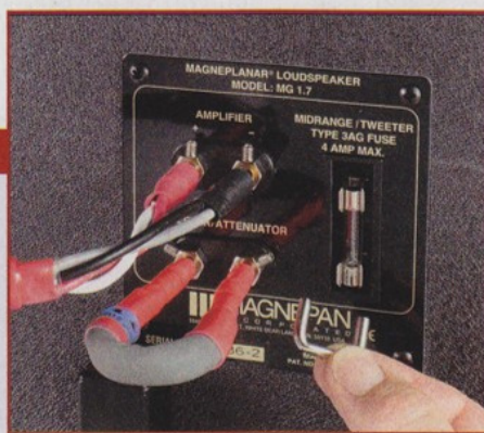
Ein Jumper aus Straight Wires Melody-Kabel ersetzt hier den originalen Blechbügel
