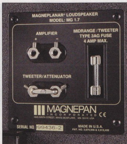
Das Anschlussfeld bietet Anschlüsse für Bananenstecker, eine Schnittstelle für Hochtonwiderstände sowie eine Sicherung gegen Überlastung
