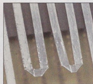
Der Magnetostat in Realität (r.) und als Schema. Die hauchdünne Mylar-Folie (1) ist mit Alustreifen (2) belegt, die sich im Feld starker Stabmagnete (3) bewegen und so die Folie antreiben. Eine gelochte Metallplatte (4) dient als Polstück. Eigentlich ist alles wie beim normalen Chassis, wobei die Alustreifen die Schwingspule darstellen
